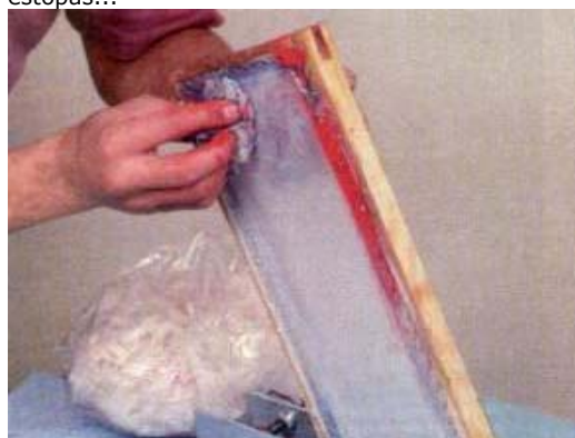
FOTO 14 - O amido de milho remove o solvente e a tinta da tela, tornando-a limpa e pronta para uma nova gravação. Esfregue a tela até retirar todo o amido de milho.
