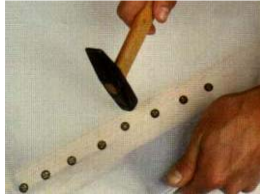
FOTO 18 - Depois que prendermos as tachinhas, vamos martelando-as para que fiquem bem firmes, sem soltar a parte do tecido que está sendo tensionada. Só soltamos o tecido depois que as tachinhas forem marteladas.
