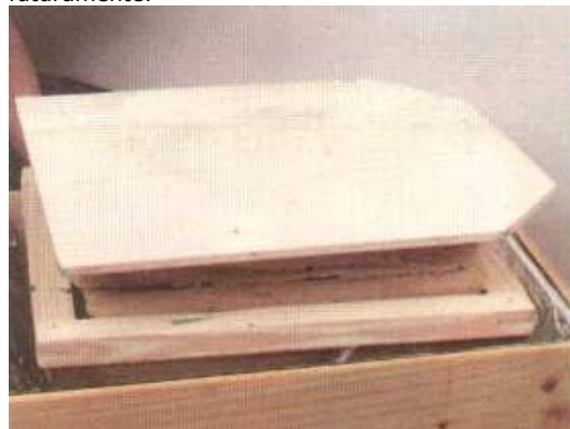
FOTO 22 - Sobre a espuma colocamos uma tábua de madeira. Esta tábua será usada para pressionar a espuma...
