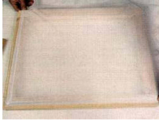
FOTO 6 - Vamos prender o 2º canto do quadro. Para fazer isto, puxamos levemente o tecido no sentido do quadro de madeira, sem forçar demais. Se fier isso, o tecido poderá rasgar onde está preso ou soltar a tachinha já fixa.
