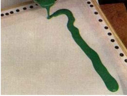
FOTO 7 - Depois de misturar bem a emulsão com o sensibilizador, derrame-o sobre a tela, sem exagerar. Não se esqueça: as luzes deverão permanecer apagadas , pois a emulsão já estará sensível à luz.
