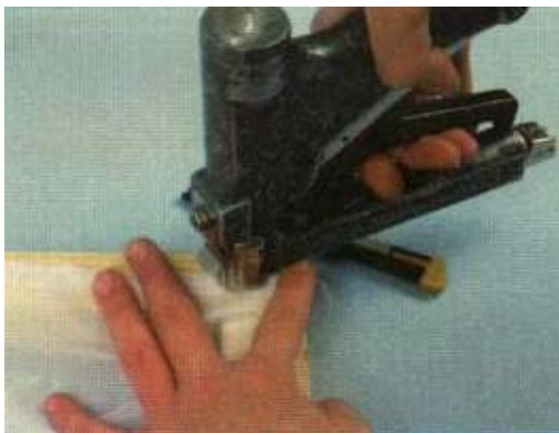
FOTO 7 - ...e aplicamos um grampo no 1º canto. Observe a maneira como o grampeador deverá ser segurado. Ele tem um gatilho tensionado por uma mola. Este gatilho aciona o grampeador, devendo ser puxado de uma só vez, com firmeza.
