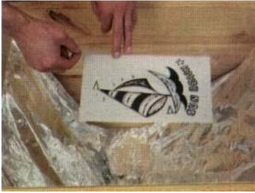
FOTO 19 - Outro modo de prender a arte final é colocá-la diretamente sobre o vidro da caixa de luz, colando-a com fita adesiva transparente, alisando-a bem...
