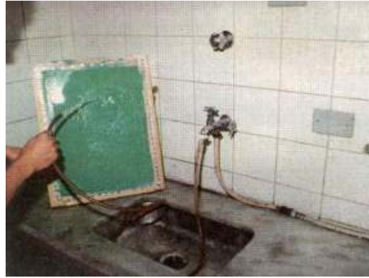
FOTO 26 - Agora a tela deverá ser lavada, para remover a emulsão da área onde o desenho impeu que a luz passasse. Primeiro lavamos bem a tela com água, para remover o sensibilizador.
