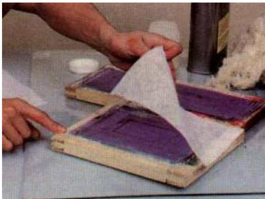
FOTO 2 - Destaque as fitas adesivas que protegem o quadro de madeira para que nenhuma parte do tecido deixe de ser umidecida com água sanitária.
