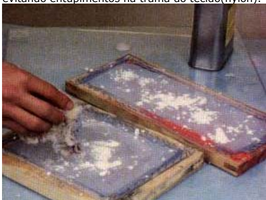
FOTO 11 - ... espalhando bem. O amido de milho também auxilia a remover a "sombra" da tela.
