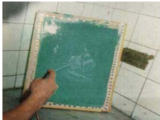
FOTO 28 - Se a tela tiver sido exposta por tempo demais a emulsão não sairá do vazado do desenho com facilidade. A tela do nosso exemplo foi gravada corretamente. Observe como o vazado começa a aparecer. O jato d'água está removendo a emulsão dos locais onde o desenho protegeu a tela da luz.
