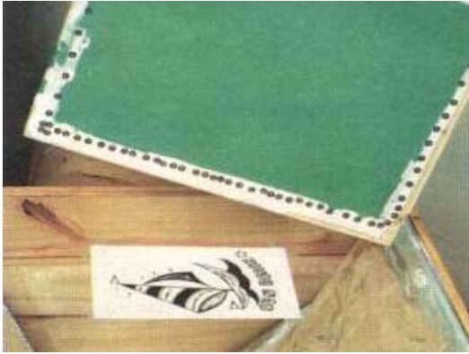
FOTO 25 - Após os 3 minutos apagamos a mesa de luz e retiramos a tela. Ela deverá ser mergulhada em água, para fixar. Depois de molhada, a emulsão deixa de ser sensível à luz, podendo-se acender a luz do local de trabalho. Você poderá ter, na câmara escura, uma bacia com água para molhar a tela.
