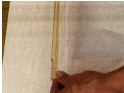
FOTO 2 - Começamos o trabalho por um dos lados do quadro. A primeira etapa é fazer uma dobra no pano. Sobre ela serão colocadas as tachinhas. Esta dobra é importante para firmar o tecido e não deixá-lo desfiar com facilidade. Lembre-se de trabalhar com o nylon úmido , para esticar melhor o tecido. O nylon é muito macio e precisa ficar bem tensionado.
