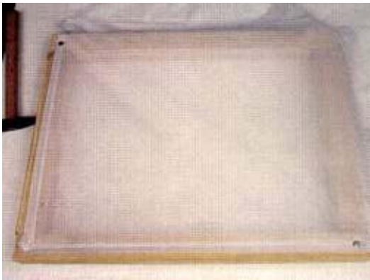
FOTO 7 - Prendemos o 3º canto do tecido no quadro, da mesma forma que prendemos o 2º canto: puxamos o tecido levemente no sentido do quadro de madeira e colocamos uma tachinha. Agora já temos 3 cantos do quadro com o tecido preso.
