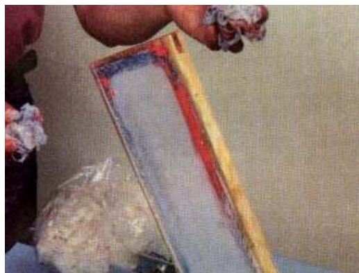
FOTO 12 -Fixe a tela na garra metálica e esfregue os dois lados do tecido da tela com auxílio de duas estopas...
