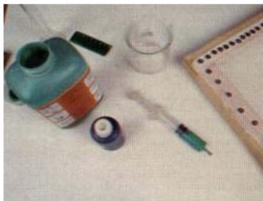
FOTO 2 - A emulsão deve ser misturada ao sensibilizador na proporção de para 1, ou seja, para 10 ml de emulsão, 1 ml de sensibilizador, para 100 ml de emulsão, 10 ml de sensibilizador e assim por diante. Se você não tiver copos graduados, poderá medir o sensibilizador com uma seringa ou mesmo marcando a graduação em copo com o auxílio de uma régua.
