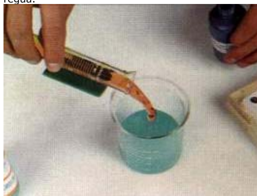
FOTO 4 - No escuro, misture o sensibilizador e a emulsão...
