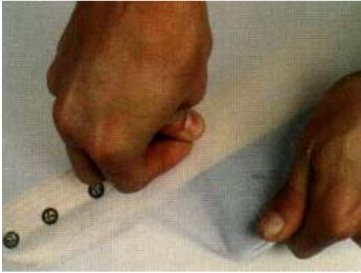
FOTO 17 - Seguimos com o mesmo procedimento, sempre usando o pedaço de madeira para tensionar o tecido, para que assim possamos prendê-lo. Devemos esticar a tela usando sempre pressão igual em cada parte do tecido que formos fixando, se isto não for feito corretamente, a tela ficará com defeitos.
