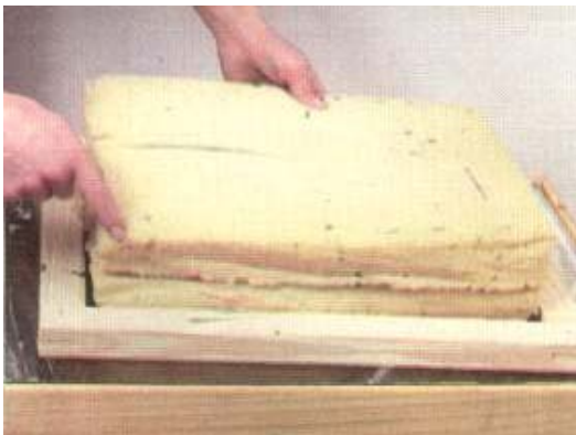
FOTO 21 - colocamos a tela sobre a mesa de luz e colocamos espumas sobre a tela. Observe que estas espumas foram cortadas no tamanho da parte interna da tela e têm uma altura de 10cm, aproximadamente. A função desta espuma é firmar a tela, pressionando-a contra o vidro da mesa de luz e contra a arte final, para que o desenho e toda a tela emulsionada fiquem bem expostos à luz.
