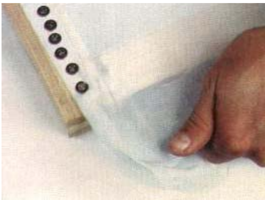
FOTO 15 - ...para que o tecido fique bem esticado e firme para colocarmos as tachinhas.
