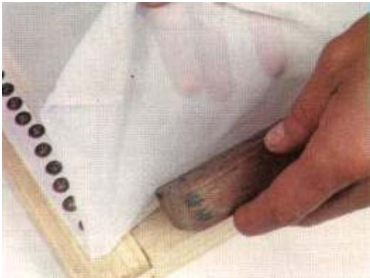
FOTO 13 - A maneira correta de usar este tipo de apoio é encaixá-lo ao quadro. Para isto, colocamos o pedaço de madeira apoiado ao quadro, o envolvemos no tecido da tela...
