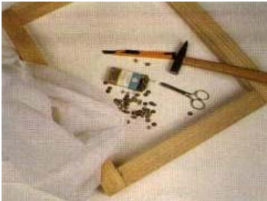
FOTO 1 - Material usado para este trabalho: nylon 77 fios, tachinhas (ou percevejos), tesoura, martelo, estilete, quadro de madeira. Observe que o quadro de madeira não está envernizado laca azul. O verniz ou a laca só serão aplicados na madeira depois que a tela estiver montada. O tecido deverá ser, pelo menos, 5cm maior que o quadro de madeira.
