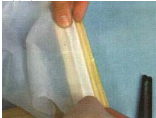
FOTO 6 - Para esticar a tela e prendê-la com grampos, procedemos quase da mesma maneira que foi mostrada no exemplo anterior, apenas substituímos as tachinhas pelos grampos. Primeiro fazemos uma dobra no tecido, em um dos lados do quadro...
