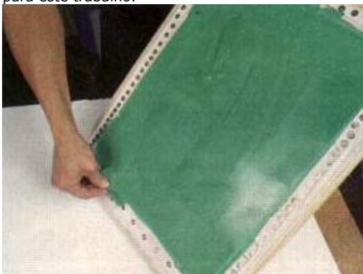
FOTO 11 - O excesso de emulsão deve ser retirado com a própria régua. Passamos a régua de baixo para cima, recolhendo o excesso, sem pressionar a tela. Trabalhe sempre com leveza, sem forçar.
