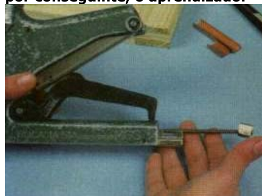
FOTO 2 - O grampeador do tapeceiro é um pouco diferente do comum, àquele utilizado para papel. Ele possui um gancho com molas para prender os grampos em seu interior. Este gancho deve ser retirado...
