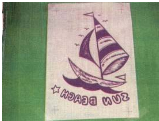
FOTO 18 - ... para que fique bem justa e presa à tela. É importante alisá-la bem, não deixando espaço entre a tela e arte final.
