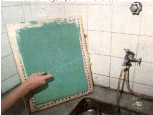
FOTO 27 - A água deve ser jogada em jatos sobre a tela, para remover a emulsão da área do desenho. É neste processo que podemos verificar a qualidade da gravação. Se a tela tiver sido pouco exposta, a emulsão se soltará da tela em vários lugares, além do desenho.
