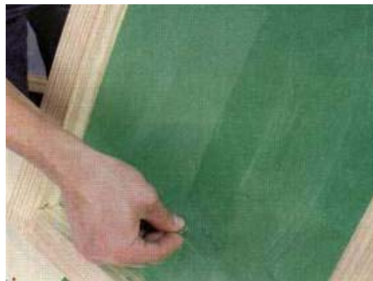
FOTO 12 - a emulsão deve ser recolhida dos dois lados da tela. Apenas uma camada fina de emulsão deve ficar aplicada ao tecido.
