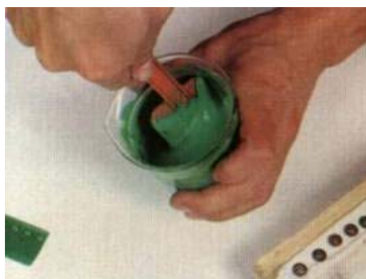
FOTO 6 - A maneira correta de proceder é mexer com a espátula, raspando bem o fundo e as paredes do copo, para a mistura ficar homogênea.
