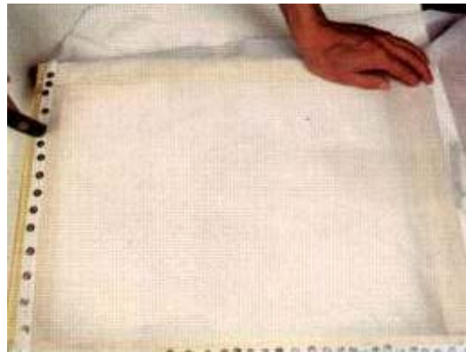
FOTO 8 - Para firmar o tecido, vamos colocar várias tachinhas prendendo os dois lados que já possuem os cantos presos. Colocamos as tachinhas distantes umas das outras a uma distância equivalente a uma cabeça de tachinha. Vamos fixando-as com a pressão do dedo. Depois que todas elas estiverem no lugar, martelamo-as para que fiquem bem presas ao quadro de madeira.
