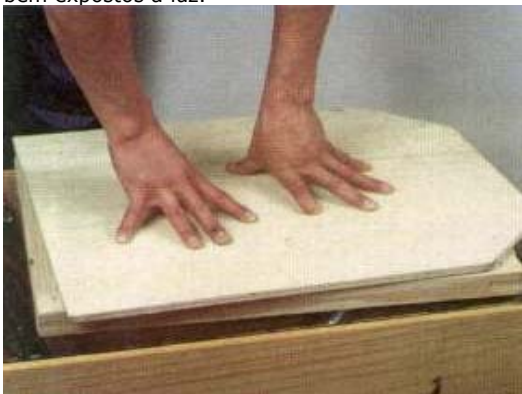
FOTO 23 - ...como mostrado nesta foto. Você poderá pressionar a tábua com as mãos ou colocando um peso sobre ela. Se usar um peso, este deverá se distribuir por igual pela tábua, pois é necessário que a pressão sobre a tela seja a mesma em toda a sua extensão.
