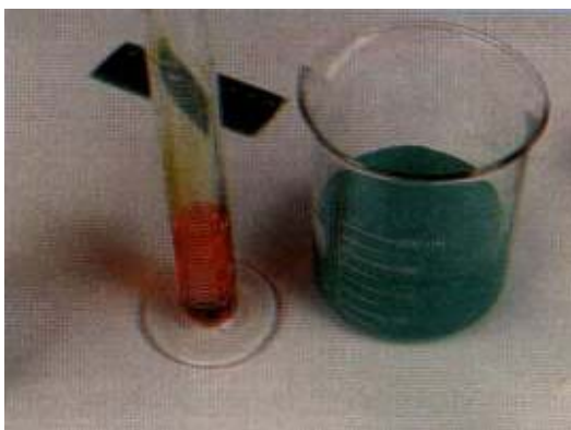
FOTO 3 - Separamos 100 ml de emulsão e 10 ml de sensibilizador. Para efeito didático, fotografamos com luz. Lembre-se: todo o trabalho de gravação deve ser realizado em câmara escura, com o auxílio de uma luz fraca colorida, como já foi mencionado.
