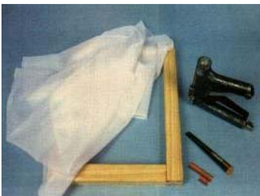
FOTO 1 - Para esticar telas e prender o tecido com grampos utilizaremos os mesmos materiais do exemplo anterior, substituindo apenas as tachinhas pelo grampeador de tapeceiro, com grampos próprios para usar com telas de silk-screen.
