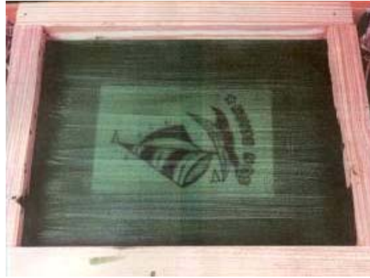
FOTO 20 - ... e centralizando a tela sobre a mesa de luz. Como você estará trabalhando no escuro, apenas com luz colorida, pode ser que ache mais fácil colocar a arte na tela. Existe um modo de colocar luz "piloto", colorida, na mesa de luz, como mostraremos futuramente.
