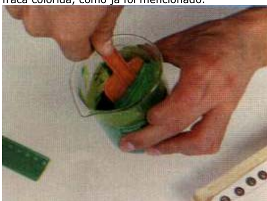
FOTO 5 - ...com o auxílio de uma espátula, mexendo bem. Observe que o sensibilizador é de cor amarelada, mudando o tom de verde da emulsão. Isto no entanto, poderá não ser bem observado no escuro, portanto mexa muito bem.
