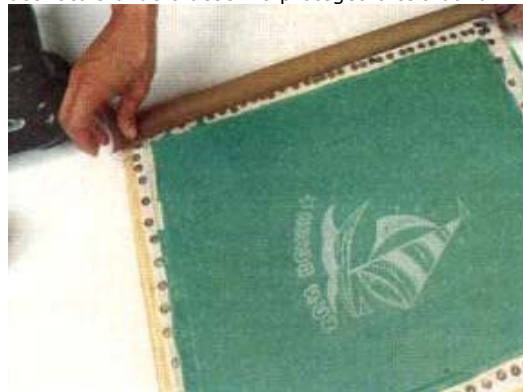
FOTO 30 - Para completar a vedação da tela, colocamos fita adesiva no quadro de madeira...
