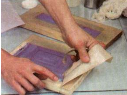
FOTO 1 -Limpe as telas, removendo toda emulsão, deixando-a preparada para uma nova gravação. Use água sanitária comum.
