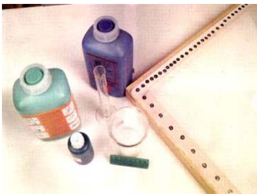
FOTO 1 - Material que iremos usar: a tela que foi montada no início desta aula, emulsão verde (emulsão para tintas à base de água), sensibilizador de emulsão, copos graduados e um pedaço de régua de plástico de 10 cm. Atenção! Colocamos a emulsão azul na foto apenas para que você possa diferenciá-las.
