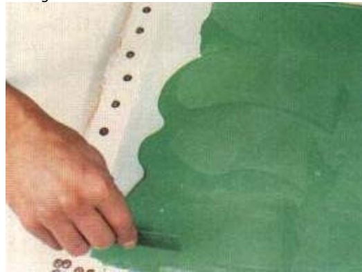
FOTO 10 - Vamos espalhando a emulsão sobre a tela de maneira uniforme.
