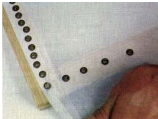
FOTO 16 - Observe como o pedaço de madeira garante a tensão do tecido para que o prendamos de forma correta. Vamos colocando as tachinhas apenas com a pressão manual, sem soltar o tecido .
