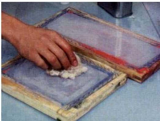
FOTO 9 -Esfregue a tela com a estopa embebida em solvente, para remover restos de tinta. Este procedimento deve ser feito também nas telas gravadas com emulsão para tintas à base de água, pois serve para auxiliar e eliminar a "sombra" evitando entupimentos na trama do tecido(nylon).
