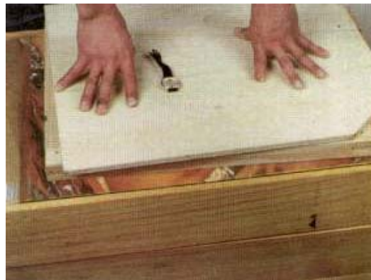
FOTO 24 - A mesa de luz deverá ser acesa e marcamos 3 minutos para a gravação. Se você confeccionar sua mesa de luz como foi ensinado, os 3 minutos serão suficientes para gravar corretamente a tela.
