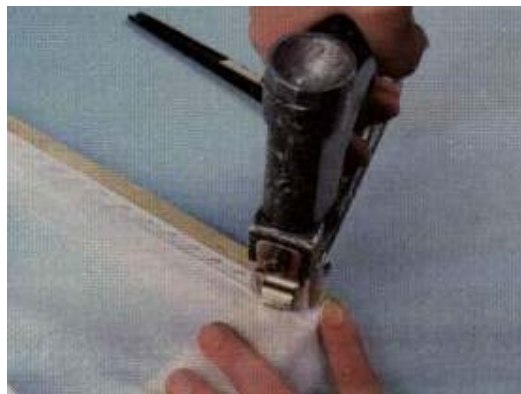
FOTO 8 - Prendemos o 2º canto do quadro, do mesmo modo mostrado no exemplo anterior. Após isso, grampeamos dois dos lados da tela, sempre colocando os grampos inclinados em relação ao tecido, nunca retos. Observe como isto é feito, através desta foto.
